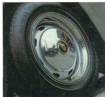
Klassische Käferfelge: 5,5J x 15" mit 165er Bereifung
